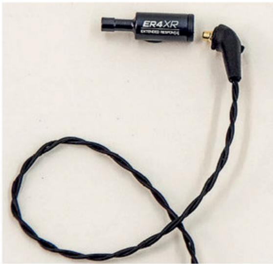
Das Kabel ist abnehmbar und wird über eine modifizierte MMCX-Steckverbindung mit dem Kopfhörer verbunden.
